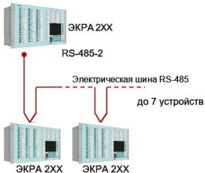
Рисунок 9 – Применение терминала в качестве концентратора данных в сети RS-485
