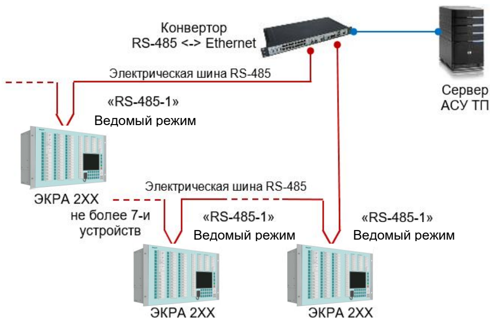
Рисунок 8 – Типовая схема интеграции терминала в АСУ ТП по электрическому интерфейсу RS-485. Комбинированная топология сети
